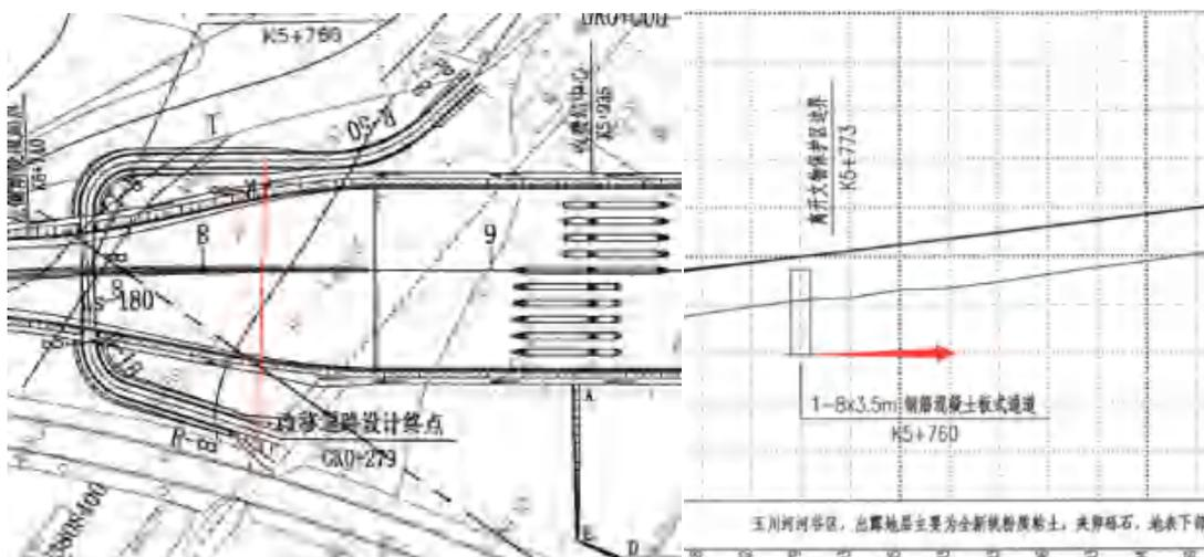
8) K5+440处改路应考虑纵向涵, 或调整蒸发池, 沿线应细化, 下穿通道的排水沟与路基边沟、蒸发池的标高的衔接, 确保通道不积水, 建议在蒸发池中标注底标高和进水口标高, 便以便核查。
