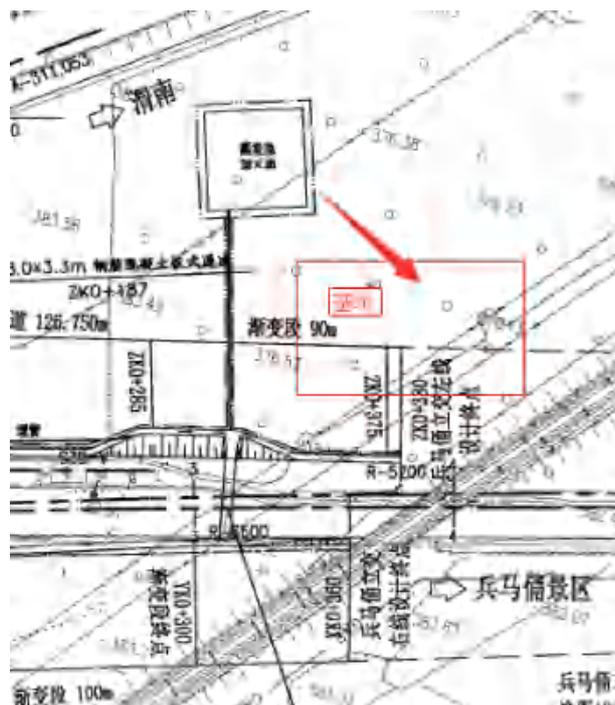
7) 建议K5+760向大桩号移至K5+820, 向大桩号移动60米, 虽然通道稍有加长增加, 但减少120米改路, 如造价变化不大, 建议减少沿线群众绕行距离。
